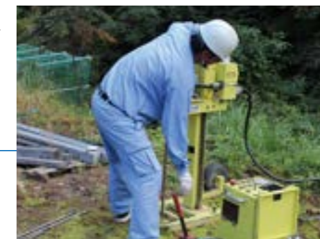
(地盤調査の状況) スウェーデン式サウンディング調査の場合、 調査後SWS値をN値に換算
